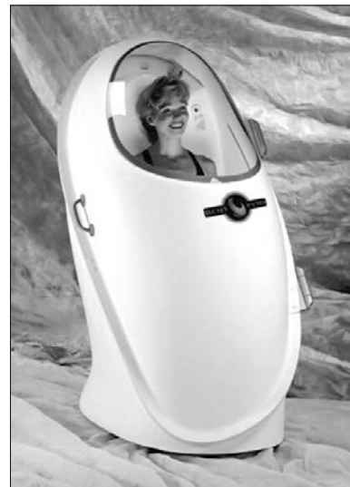
Рисунок 6.26 Плетизмограф Bod Pod (Life Measurement Instruments, США). Внешний вид [19]
